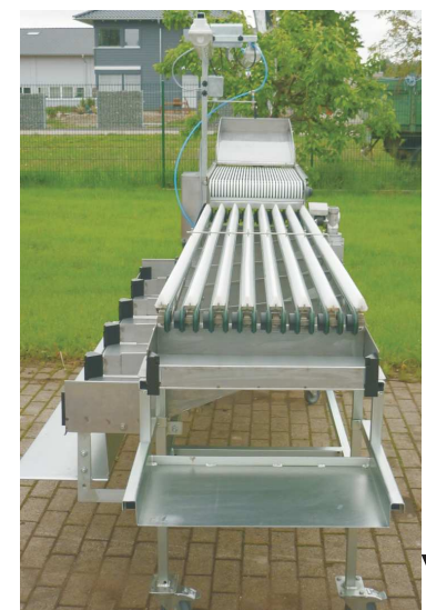
Variable Sortierfächer; Breite individuell einstellbar
