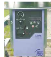
Elektro-Antrieb mit Frequenzregler (stufenlose Geschwindigkeitsregelung)
