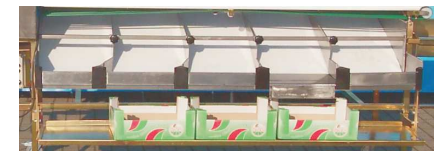
Variable Sortierfächer; Breite individuell einstellbar
