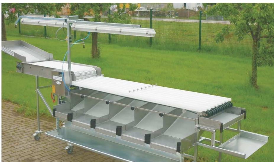
Vorsortierband Zur manuellen Vorsortierung
