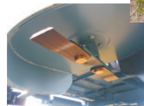
Oben: Arbeitsergebnis von Schwenscheibe und Stockputzer Links: Messerkreisel in Schwenscheibe
