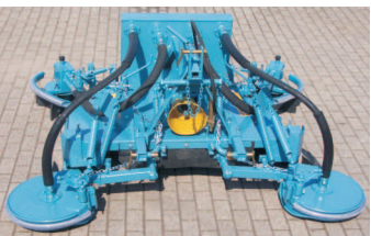
Oben: Aufhängung von Schwenscheibe Unten: Frontalansicht Mulchgerät von Schlepper aus gesehen
