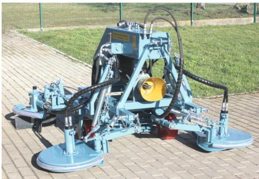
**Das hydraulisch breitenverstellbares Gerät arbeitet mit Schwenkscheiben und Stockputzern.**
