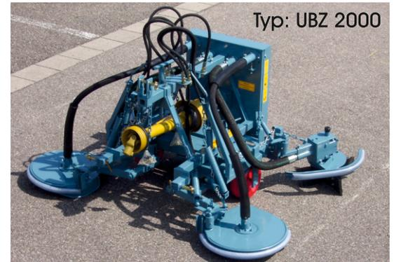
**Schwenscheiben:** Die Schwenscheiben mit Messerkreisel (ca. 450 mm Durchmesser) mähen das Gras im Bereich zwischen den Stöcken. Die Schwenscheiben sind mit Zugfedern so aufgehängt, dass sie sich in alle Richtungen frei bewegen können. Dadurch wird ein leichtgängiges Einschwenken entlang des Rebstocks ermöglicht.
