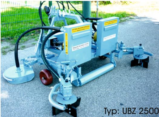
Das hydraulisch breitenverstellbare Gerät arbeitet mit Schwenscheiben und Stockputzern.
